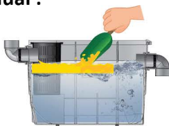
Bersihkan Lemak/Minyak diruang tengah dengan sendok secara manual
